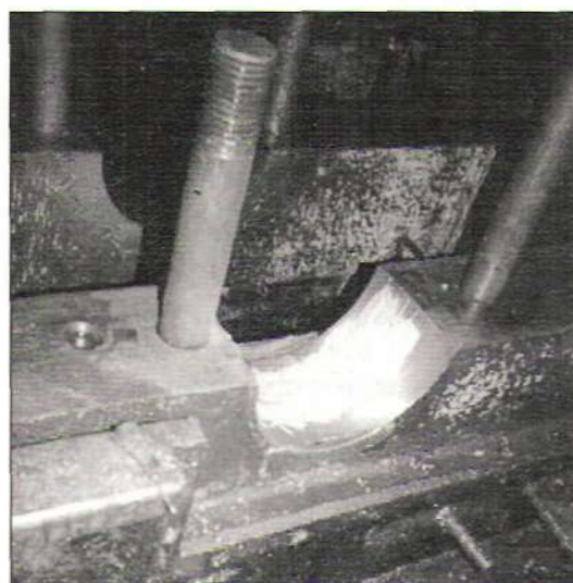
Рис. 3. Поверхность гнезда с нанесенным избытком металлополимерного материала
