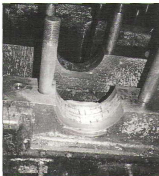
Рис. 2. Изношенное гнездо, подготовленное к нанесению металлополимерного материала «мультиметалл»
